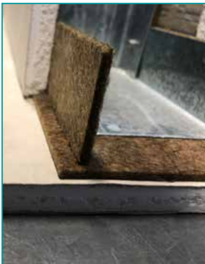
Taglio termoacustico con Nobilium®Thermalpanel da 3mm per le strutture a “secco”.
